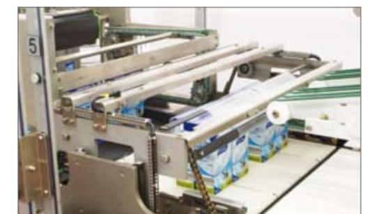
Praktisch: die ausziehbare Station für den Folientransport.
